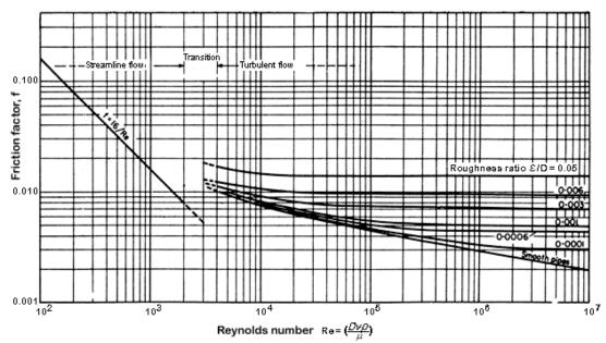
請協助某工程師估計原油(*p*=860 kg/m<sup>3</sup>; μ=0.0009 kg/m-s)以 0.316 公升/秒流量流過總長 10 米之1 吋鐵管(ε=0.046 mm)的壓力降。(6 分)
