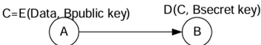
(圖：數位簽章示意圖，圖中E與D代表加密與解密，收送兩端將使用相同的雜湊函數進行)
