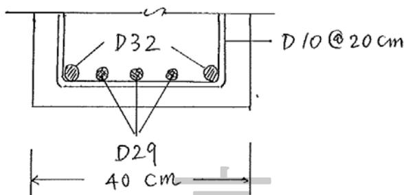
故主筋採用 2-D32 搭 3-D29，箍筋 D10@20cm
