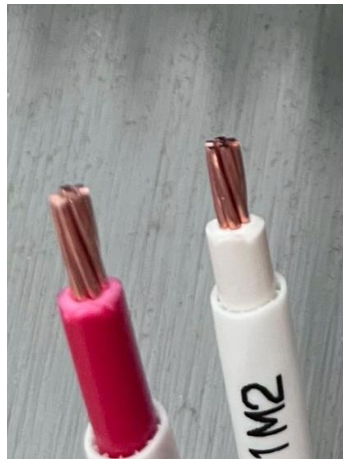
圖 3 剝線時銅導體完整
